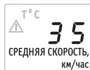
Когда температура окружающей среды около 0°С (от -2°С до +2°С) на дисплее мигают символы "Δ" и "Т°С" и периодически раздается предупреждающий звуковой сигнал. Когда температура окружающей среды выйдет из опасного диапазона (от -2°С до +2°С) предупреждение исчезнет.
